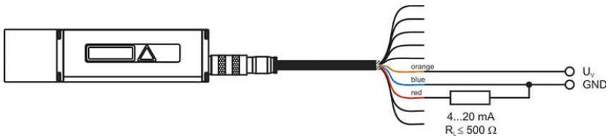
Abbildung 20 : Beschaltung Analogausgang
